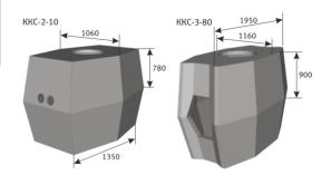
Колодцы ККС предназначены для протягивания, монтажа, проверок, ремонта и эксплуатационного обслуживания кабельной связи. Кабельные колодцы состоят из двух составных частей (половин): нижней (с днищем и половиной боковых стен) и верхней (с половиной боковых стен) и верхним перекрытием]. В перекрытии колодца предусмотренно круглое отверстие, над которым
