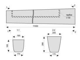
Железобетонные стойки СВ-110-3.5 [Серия 3.407.1-143] предназаначены для высоковольтных линий электропередачи до 10 кВ и устройства опор освещения.
