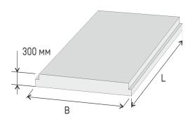
Предназначены для устройства перекрытий и покрытий жилых и общественных зданий высотой до пяти этажей. Плиты рассчитаны на расчетную нагрузку  $600 \, \text{кг/м}^2$ .
