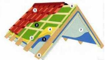
\* необходимо обеспечить вентилируемый зазор min 2 см между гидроизоляцией и утеплителем.
