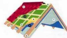
\* необходимо обеспечить вентилируемый зазор min 2 см между гидроизоляцией и утеплителем.
