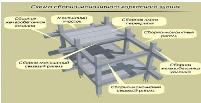
Ригеля для сборно-монолитного каркаса сечением до 400x600 мм
